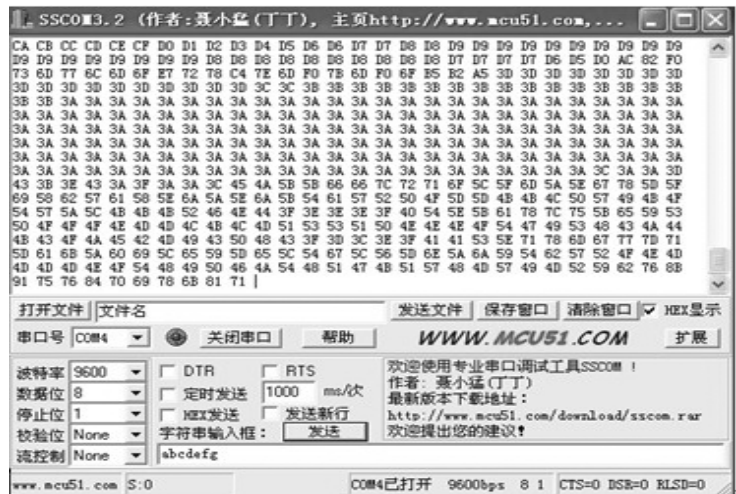
图4 测试单片机串口发送数据
